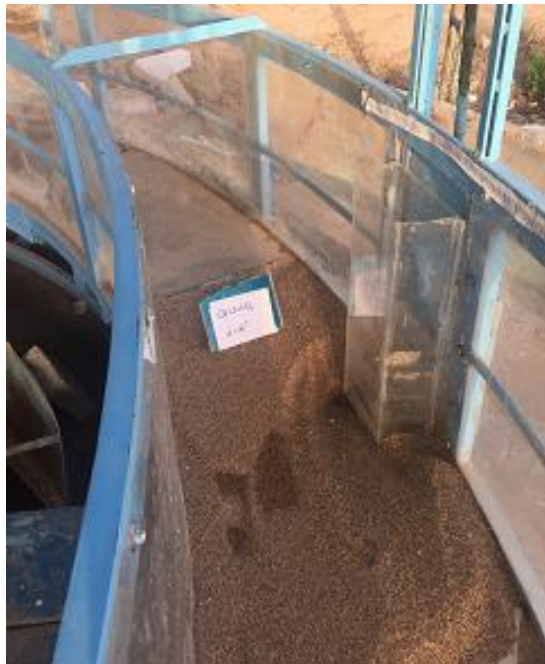
شکل ۲: آبشستگی در اطراف تکیه‌گاه
