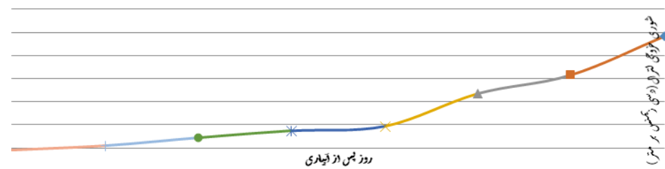
شکل ۹: شوری (EC) آب خروجی از زهکش‌های زیرزمینی در مزرعه دو
