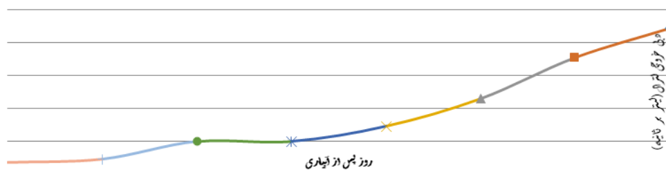
شکل ۸: دبی خروجی از زهکش‌های زیرزمینی در مزرعه دو
